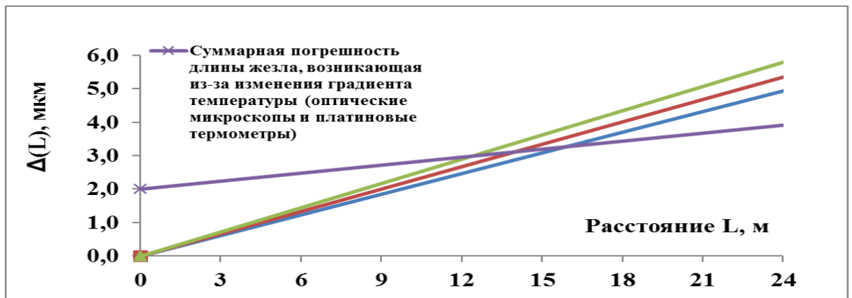
Рисунок 2.2 - Рисунок 2.2 Диаграммы сравнения точности линейных измерений лазерным интерферометром и на оптико-механическом компараторе при разных градиентах температуры
